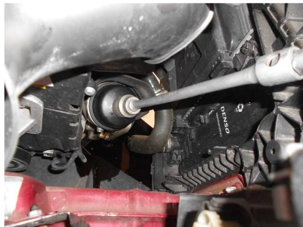
Remonter le bouchon de vidange avec un joint neuf, serrez à **1.4 daN.m**
