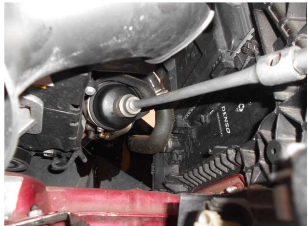
Montage du filtre neuf, changer le joint sur la cloche
