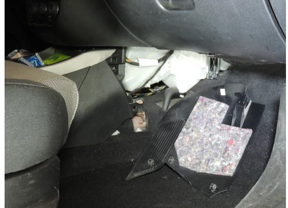
Déclipsez la garniture sous la boite à gants, déposez la fermeture du filtre
